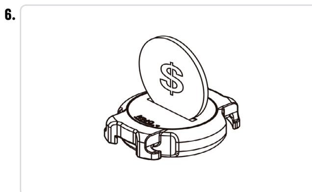
Per sostituire la batteria, ruotare il coperchio **APRIRE** direzione, rimuovere la batteria e inserire una nuova batteria CR2032. Chiudere il coperchio e riconfigurare il sensore, se **CADENZA o PEDALATA**.
