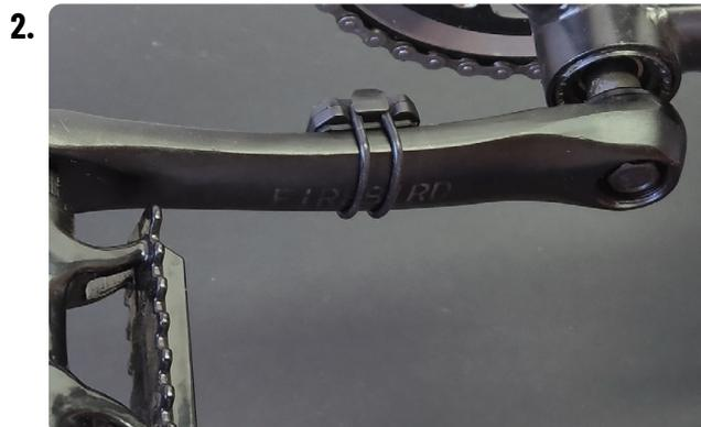
Installare il sensore di **CADENZA** sul lato interno del pedale opposto alla corona della catena, utilizzando l'anello in gomma, il più vicino possibile all'asse. Ogni volta che il sensore si attiva all'inizio del movimento del pedale, la spia blu si accenderà per 2 secondi..
