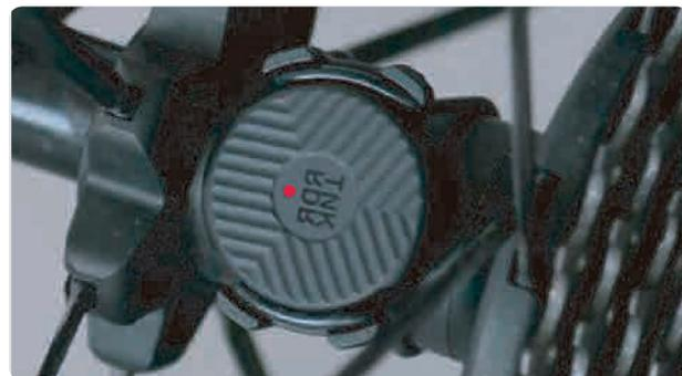
Installare il **VELOCITA** sensore sui raggi della ruota posteriore con l'anello di gomma.
