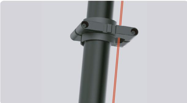
Se la bici è dotata di ingranaggi, far passare i cavi attraverso il foro nella staffa fissa mostrato in figura. Assicurarsi che l'area di bloccaggio del supporto fisso sia sempre orientata verso il lato di montaggio delle spine.
