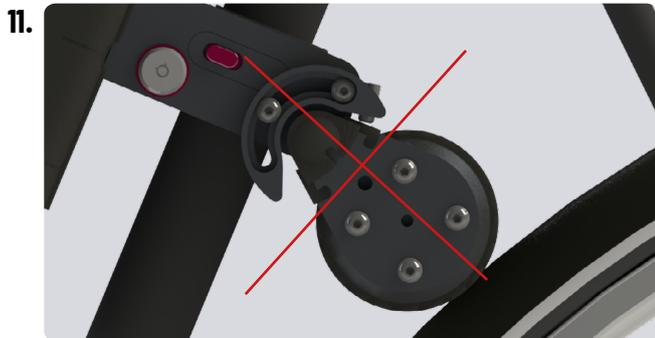
**Posizionamento SPINY errato:** Il motore applica una pressione insufficiente contro il pneumatico. Controllare la posizione del supporto fisso utilizzando il manometro in plastica (punto 4), quindi regolare nuovamente i limiti di movimento del motore.
