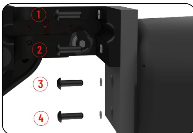
In primo luogo, allegare **Adattatore 0** singolarmente utilizzando le due viti M4 x 14 mm con rondelle (1 e 2) incluse nel kit. Quindi, fissare il supporto utilizzando le due viti e le rondelle originali (3 e 4).
