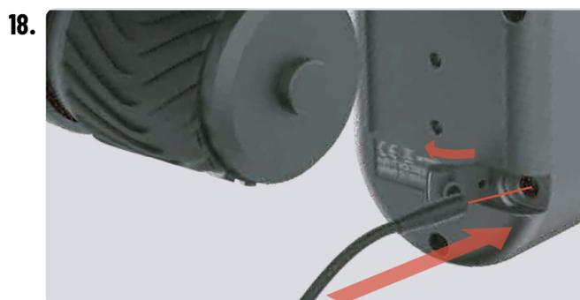
Caricare lo Spiny collegando il caricabatterie al perno di ricarica posteriore. Eseguire una carica completa di 4 ore prima del primo utilizzo. L'indicatore luminoso del caricabatterie cambia da rosso a verde quando la carica è completa. **I LED SPINY lampeggiano in rosso quando la batteria è scarica.**
