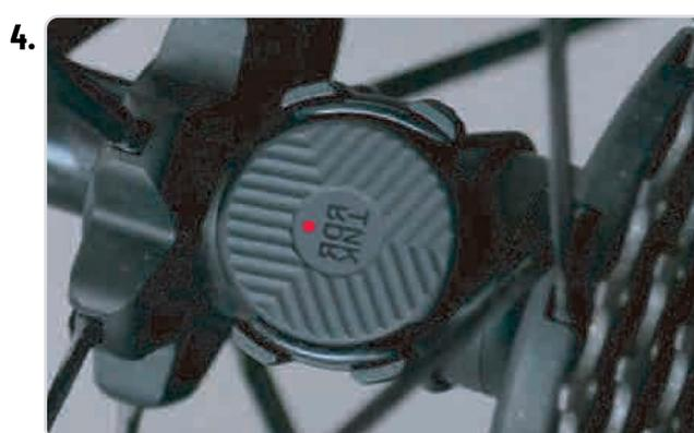
Posizionare il **VELOCITÀ** sensore sul mozzo della ruota posteriore utilizzando l'anello di gomma. La luce rossa si accende solo durante il processo di configurazione, non si accende più una volta attivato.
