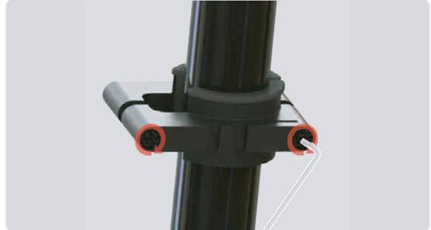
Posizionare la staffa fissa sul tubo sella del telaio utilizzando la chiave a brugola, senza serrarla completamente. Posizionare lo slot del cavo in avanti per creare più spazio per il motore (posizione A), o indietro per avvicinare il motore alla ruota (posizione B). Controllare la distanza usando lo strumento spaziatrice.
