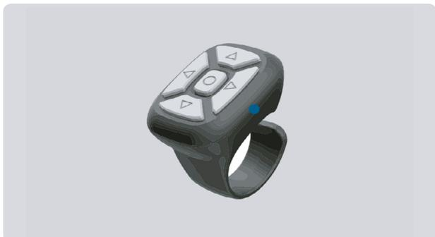
Tenere premuto il pulsante centrale del telecomando per 3 secondi fino a quando l'indicatore laterale blu si accende. La spia continuerà a lampeggiare fino a quando il telecomando non sarà abbinato allo SPINY. Con Spiny on, premere due volte il pulsante avanti per attivare la modalità di accoppiamento.
