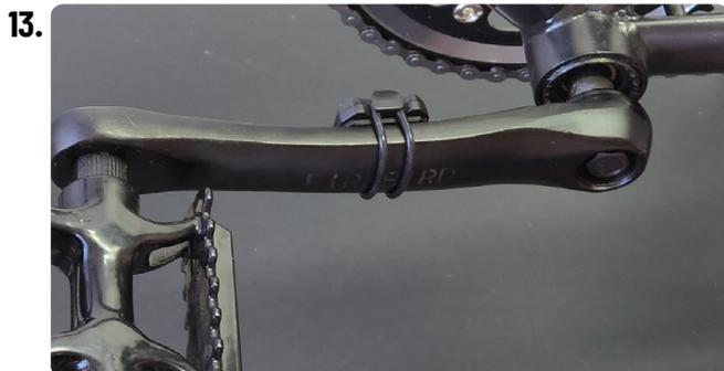
Installare il sensore di **CADENZA** sul lato interno del pedale opposto alla corona della catena, utilizzando l'anello in gomma, il più vicino possibile all'asse.
