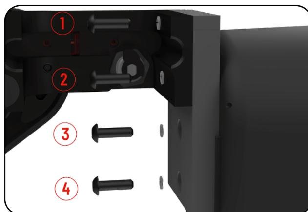
D'abord, attachez **Adaptateur 0** à l'unité à l'aide des deux vis M4 x 14 mm avec rondelles (1 et 2) incluses dans le kit. Ensuite, fixez le support à l'aide des deux vis et rondelles d'origine (3 et 4).
