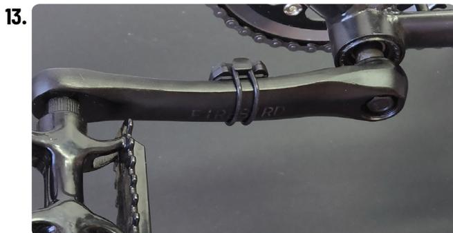
Installez le capteur de **CADENCE** sur la face interne de la pédale opposée au plateau de la chaîne, à l'aide de l'anneau en caoutchouc,
