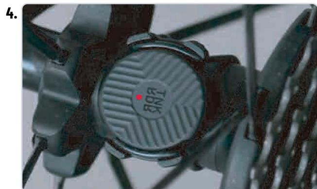
Placez le **VITESSE** capteur sur le moyeu de roue arrière à l'aide de l'anneau en caoutchouc. Le voyant rouge s'allumera uniquement pendant le processus de configuration, il ne s'allumera plus une fois activé.
