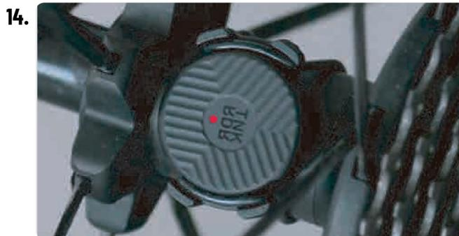
Installez le **VITESSE** capteur sur les rayons de la roue arrière avec l'anneau en caoutchouc.
