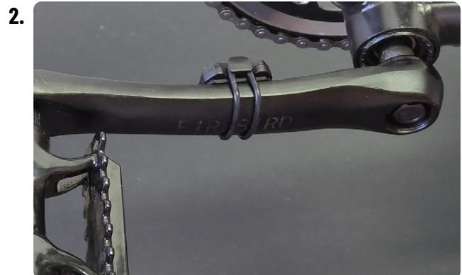
Installez le capteur de **CADENCE** sur la face interne de la pédale opposée au plateau de la chaîne, à l'aide de l'anneau en caoutchouc, le plus près possible de l'axe. Chaque fois que le capteur s'active au début du mouvement de la pédale, le témoin bleu s'allume pendant 2 secondes.
