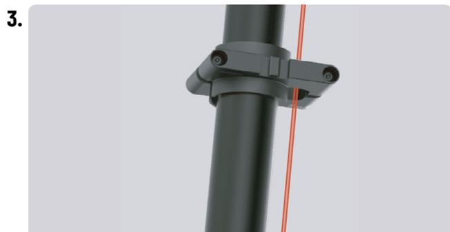
Si le vélo est équipé d'engrenages, acheminez les câbles à travers le trou du support fixe illustré sur l'image. Assurez-vous que la zone de verrouillage du support fixe est toujours orientée vers le côté de montage des épines.
