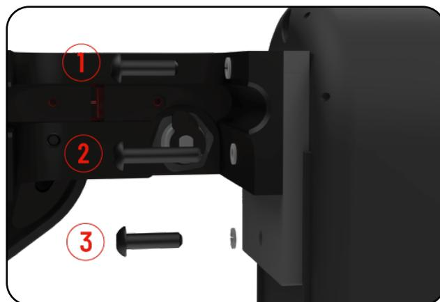
D'abord, attachez **Adaptateur I** à l'unité en utilisant l'une des deux vis d'origine avec sa rondelle (1). Ensuite, fixez le support à l'aide de la vis d'origine restante avec sa rondelle (3), et enfin de la vis M4 x 20 mm avec sa rondelle (2) incluse dans le kit.
