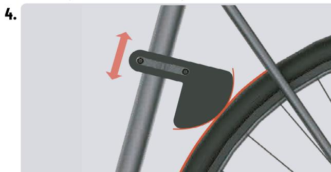
Avant de serrer EA les vis, placez le calibre et soulevez ou abaissez le support fixe de sorte que la roue touche un point tangent sur l'étrier. **PRUDENCE! Si les vis ne sont pas fermement serrées, l'équipement peut tourner et être endommagé.**
