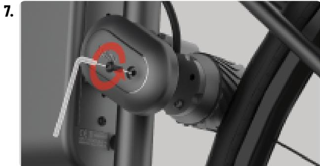
Retirez le couvercle du moteur à l'aide de la clé Allen pour calibrer la position du moteur et, après les étapes 8, 9 et 10, remettez-le en marche.
