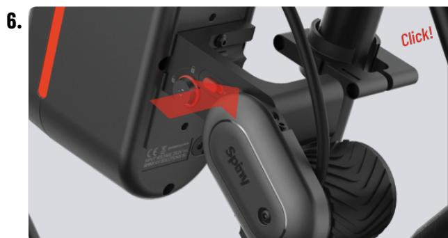
Une fois le support fixe fixé, attachez l'SPINY jusqu'à ce qu'il s'enclenche! Vérifiez qu'il est aligné avec la roue.
